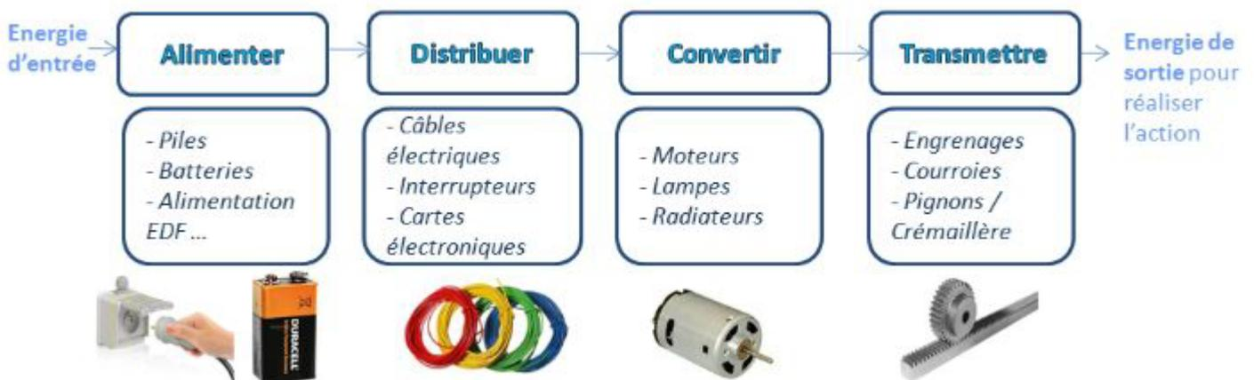
Le fonctionnement d'un objet technique peut être expliqué en comprenant comment circule et se transforme l'énergie dans cet objet. Pour représenter cela on utilise un schéma appelé chaîne d'énergie.
